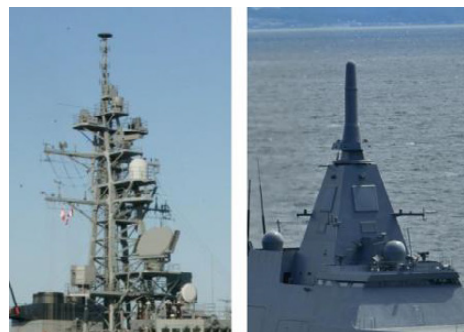
複数のアンテナが取り付けられている護衛艦のマスト(左)と「もがみ」に装備された「UNICORN」(出典：海上自衛隊ホームページ)
