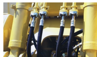
建設機械に装着されている高圧ホース
