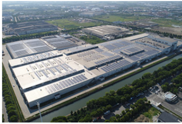
太陽光発電（中国：蘇州） 設備容量：3,000kw
