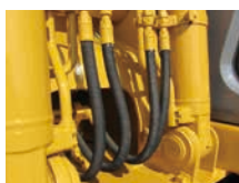
建設機械に装着されている 高圧ホース
