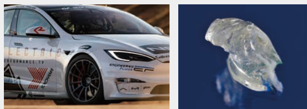
サステナブル素材を採用した「ADVAN A052」を装着し参戦したEV バイオマス由来のブタジエンゴム素材
