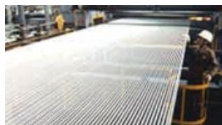
1970年 幅3.2メートルのスチールコード・コンベヤベルトが製造できるドイツ製装置を平塚製造所に導入
