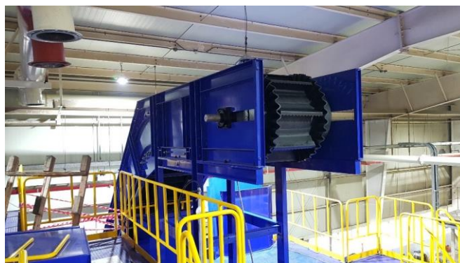
急傾斜コンベヤベルトシリーズ「Z」の難燃耐油性商品
