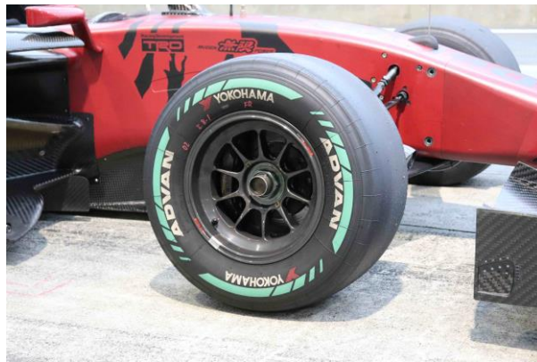
再生可能原料比率約 60%のドライ用「ADVAN」プロトタイプレーシングタイヤ
