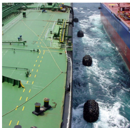
2 船体間荷役作業で使われる空気式防舷材
