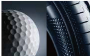
■空気抵抗低減の原理はゴルフボールと同じ
