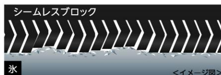
進化した「スーパー吸水ゴム」の性能をさらに発揮するために、細かく刻んだブロックが互いの倒れ込みを抑制しつつ、均一な接地圧で氷路面の凹凸にしっかり
