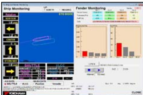
「2船体操船および係留監視システム」のモニタリング画面
