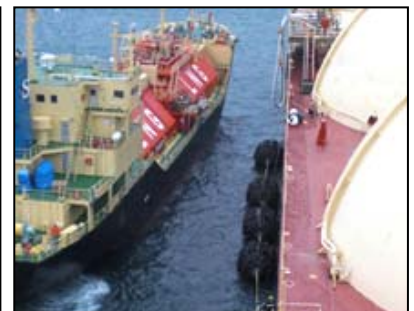
LNGの2船体間荷役
