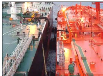
2船体間に配置される空気式防舷材
