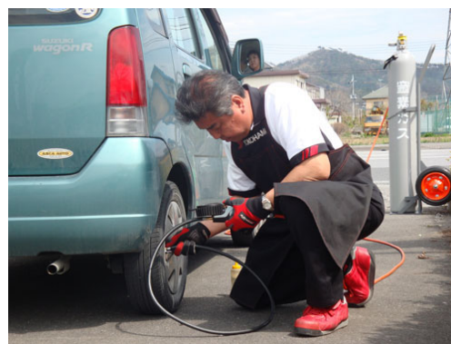
空気圧を点検している様子
