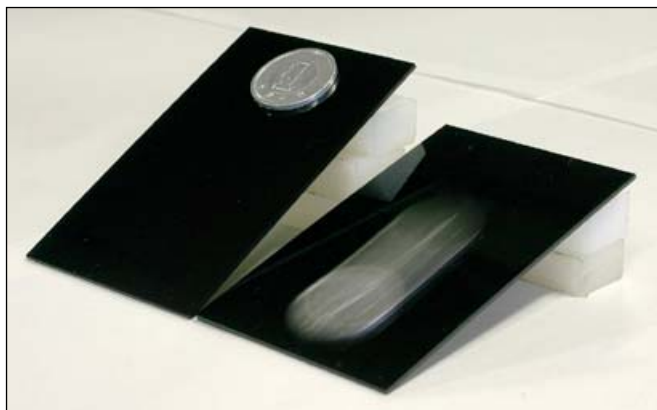
写真右がスリップ性に優れる「VH323」、左が従来品である「VH322F」を塗布したABS板。それぞれに1円硬貨を乗せた実験では、「VH323」の方がより低い角度で滑り出す。
