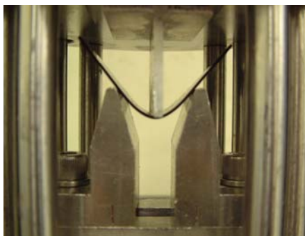
VH322F を塗布した樹脂材の曲げ試験
