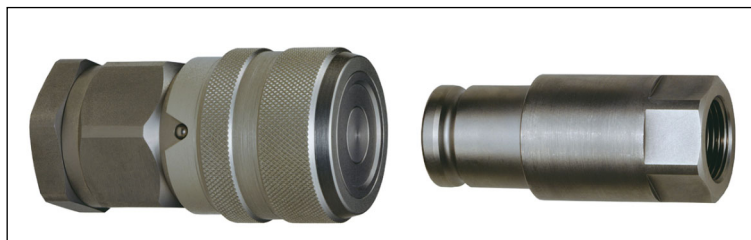
34.5MPa 油圧用カップリング「YS930」。メスハーフ(左)とオスハーフ(右)を結合する際のスリーブ操作が不要
