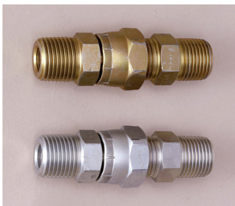
六価クロムによるクロメート処理を施した金具(上)は金虹色の皮膜が得られるが、三価クロムを使用した金具(下)は銀色の皮膜を形成する
