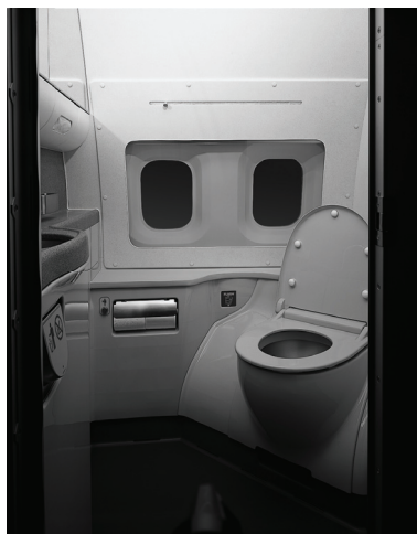
ビジネスジェット仕様の B737 向け ラバトリー・モジュール
