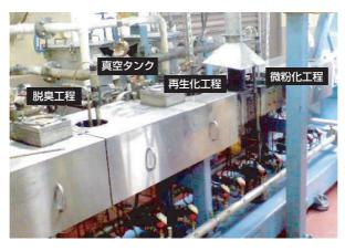
再生処理設備に導入した 「二軸スクリュー押出機」。 新品ゴム同様の高品質再生 ゴムの生産を可能とする。
