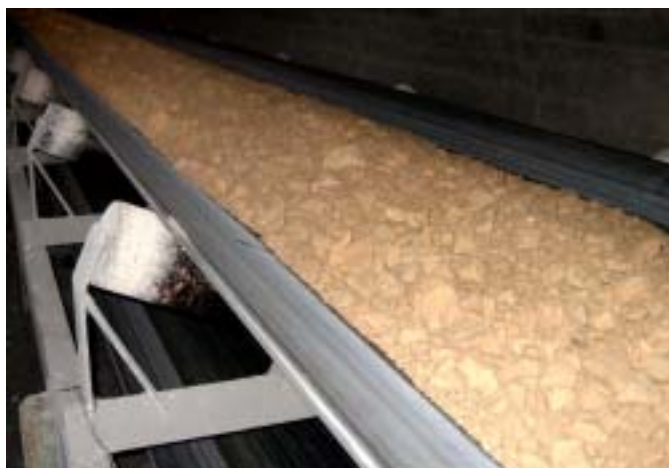
国内の石灰石鉱山で使用されているエコテックスベルト
