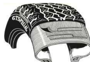
乗用車用ラジアルタイヤの構造
