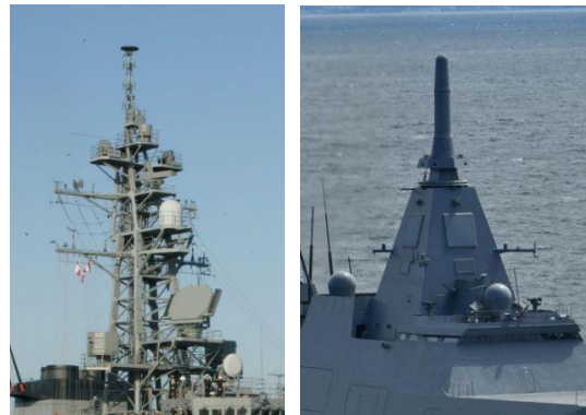
複数のアンテナが取り付けられている護衛艦のマスト（左）と「もがみ」に装備された「UNICORN」（出典：海上自衛隊ホームページ）
