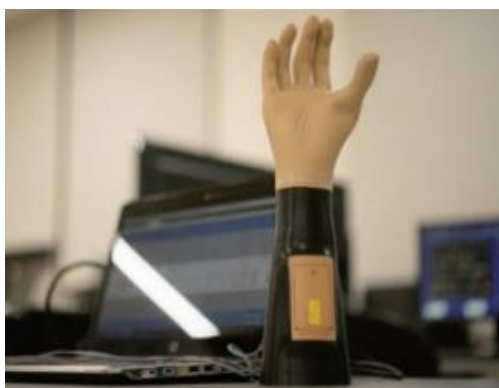
腕の筋肉から発生するわずかな電流に反応し、 自分の意思で手指を動かすことができる筋電義手
