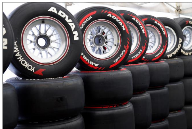
2017年の全日本スーパーフォーミュラ選手権で使用された ミディアムコンパウンドタイヤとソフトコンパウンドタイヤ（赤ライン）
