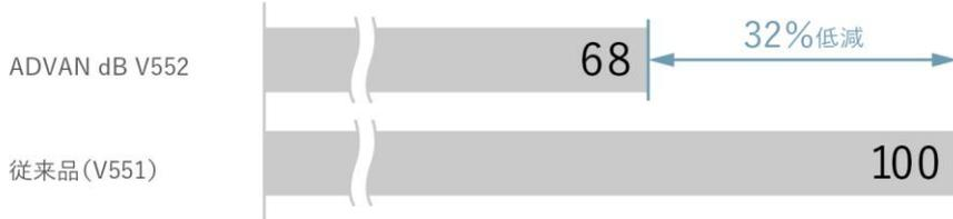
●ロードノイズ(試験方法)当社テストコース内ロードノイズ路を走行した際の60km/h速度での車内音を計測。〈試験条件〉タイヤサイズ:215/55R17 94W V552、215/55R17 94W V551、リムサイズ:17x7J、空気圧230kPa、荷重2名乗車相当、車両トヨタ クラウン(DBA-GRS210、2499cc、後輪駆動)、マイク位置:前席運転席の助手席側耳位置
